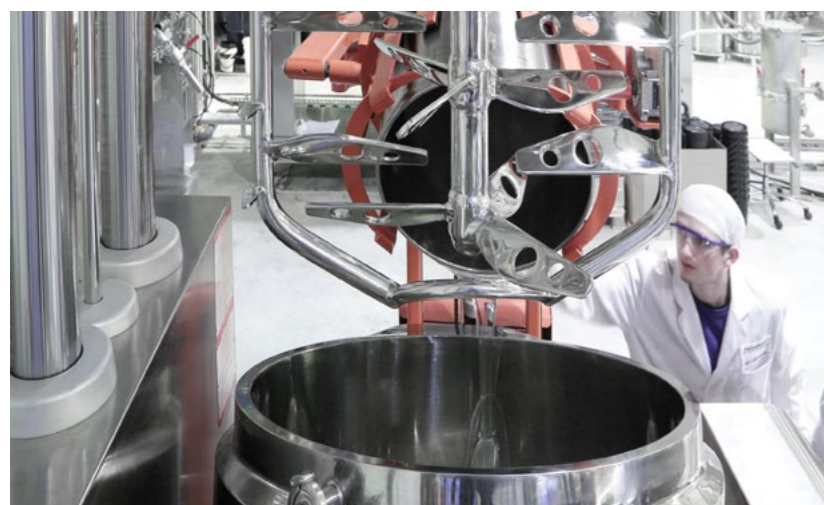
◀ Charging of our 150-l-mix-tank / Befüllung eines 150-L-Mischbehälters
